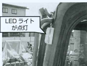
重機外部に取り付けた LED ライトが点灯
