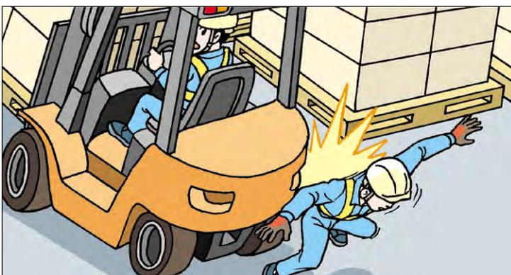
コンテナへの荷積み場所となっているフォークリフト走行エリア内でフォークリフトを運転していました。フォークリフトを後退させたところ、近くを歩いていた被災者に接触しました。なお、被災者は社内ルールで定められているフォークリフト走行エリアに入ったことで接触しました。
