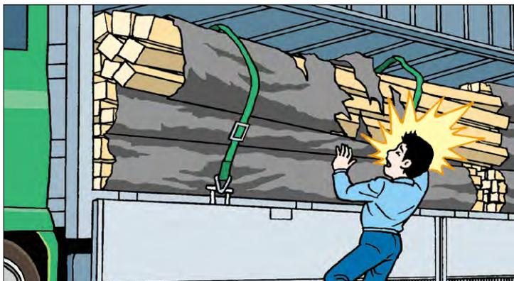
被災者は、トラック（ウイング車）の積荷である角材180本の束の積み付け状況を点検していました。角材はラッシングベルトで固定されていたものの、点検のためベルトを緩めたところ、角材の束が崩壊し、被災者は角材の下敷きになりました。なお、同被災者は保護帽を着用していませんでした。
