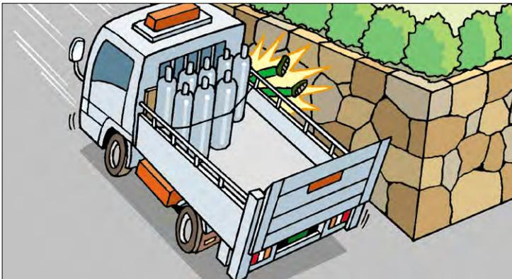
被災者（ドライバー）は、傾斜のある道路（7～9度）に駐車させていた無人のトラックが後ろに動き出したため、止めようとして運転席に乗り込もうとしましたが、振り落とされた結果、トラックと石垣との間に挟まれました。なお、トラックを駐車させた際、エンジンは停止されていましたが、トラックのパーキングブレーキは緩く、ギアロックがされていなかったために、適切にブレーキが利いていない状態でした。
