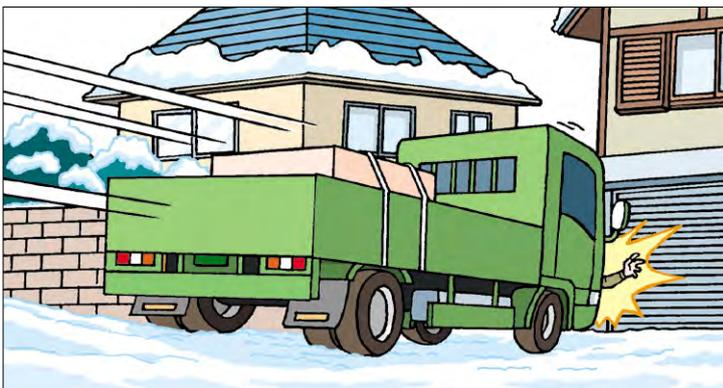
積雪し、傾斜のある道路（約10度）に停車させていた無人のトラックが前方に動き出したため、トラックの前にいた被災者（ドライバー）がトラックに押しやられ、住宅ガレージの支柱との間に挟まれました。なお、駐車時にはパーキングブレーキが適切に使用されていたほか、エンジンが停止され、ギアロックもされており、タイヤにはチェーンも装着されていました。
