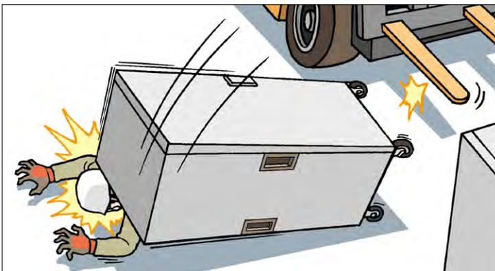
オペレーターがフォークリフトのフォークを上昇させた際に、そばにあったコールドロールボックスパレットがフォークに引っかかり、前方に倒れました。パレットの近くで作業を行っていた被災者は倒れてきたパレットを避けることができず、倒れたパレットの下敷きとなりました。
