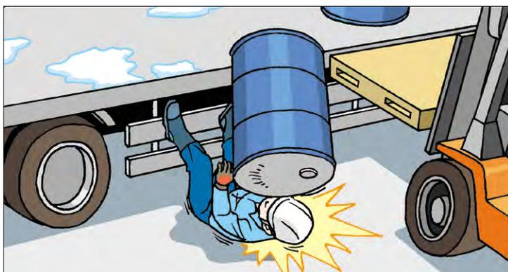
被災者は、積載されているドラム缶を、トレーラーコンテナの奥からフォークリフトのあるトラック荷台側面に移動させる作業をしていましたが、コンテナから地面へドラム缶とともに転落し、ドラム缶が被災者に直撃しました。なお、コンテナ内部の底面には雪が残っており、非常に滑りやすい状態でした。
